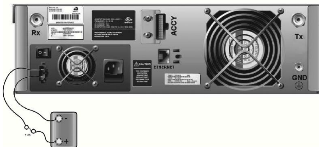
Рис. 4-2: Подключение к резервной батарее.
