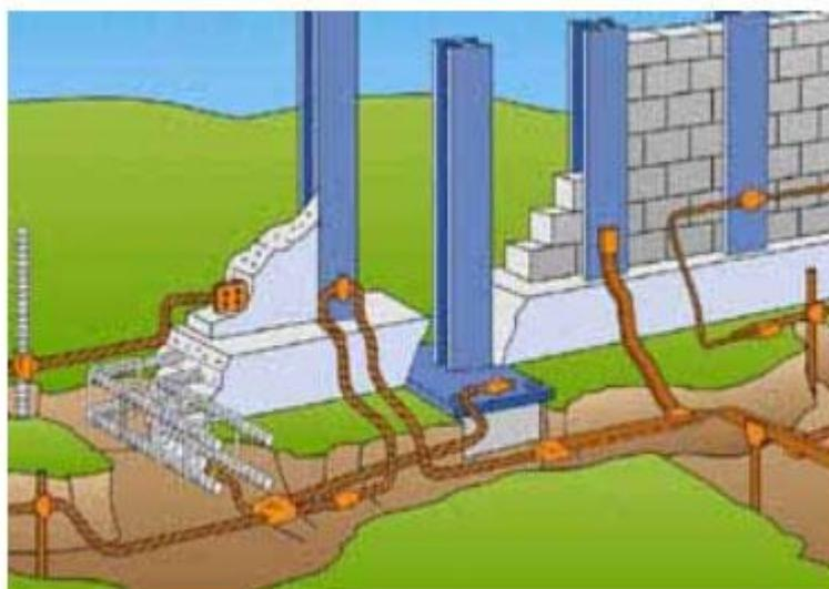
Рисунок 14. Оформление нескольких линий заземления и соединений
