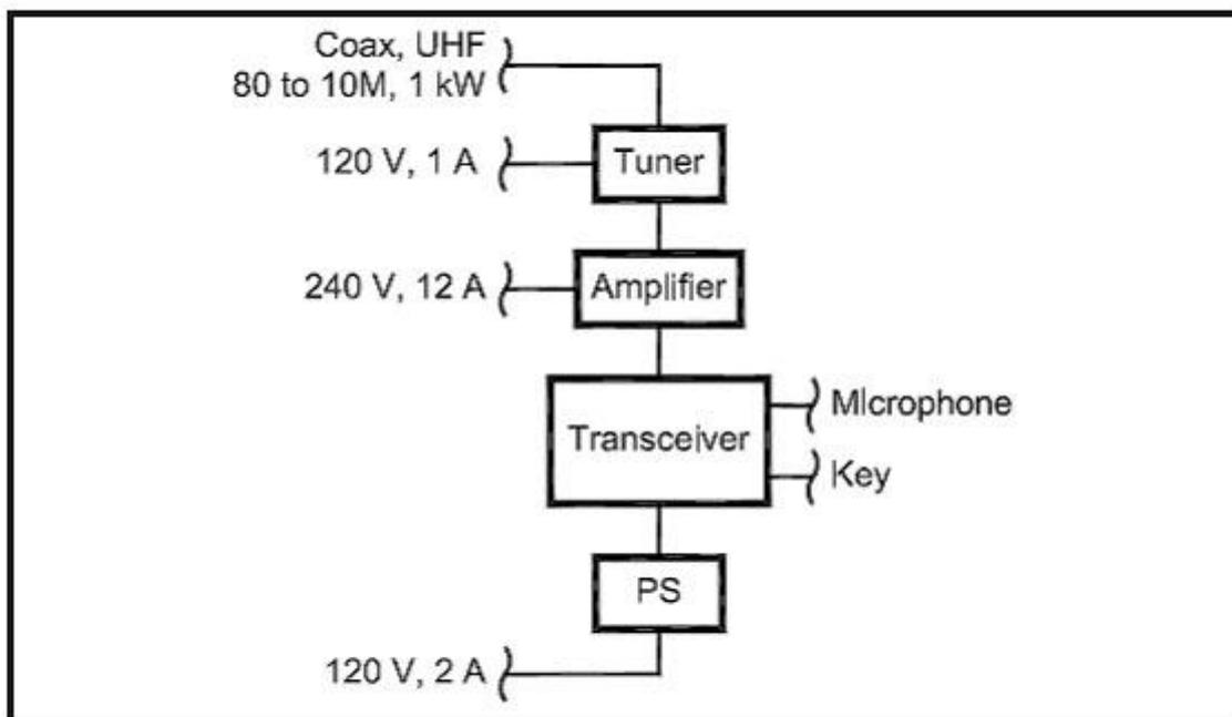
Рисунок 3. Блок-схема типичной простой HF радиостанции.
