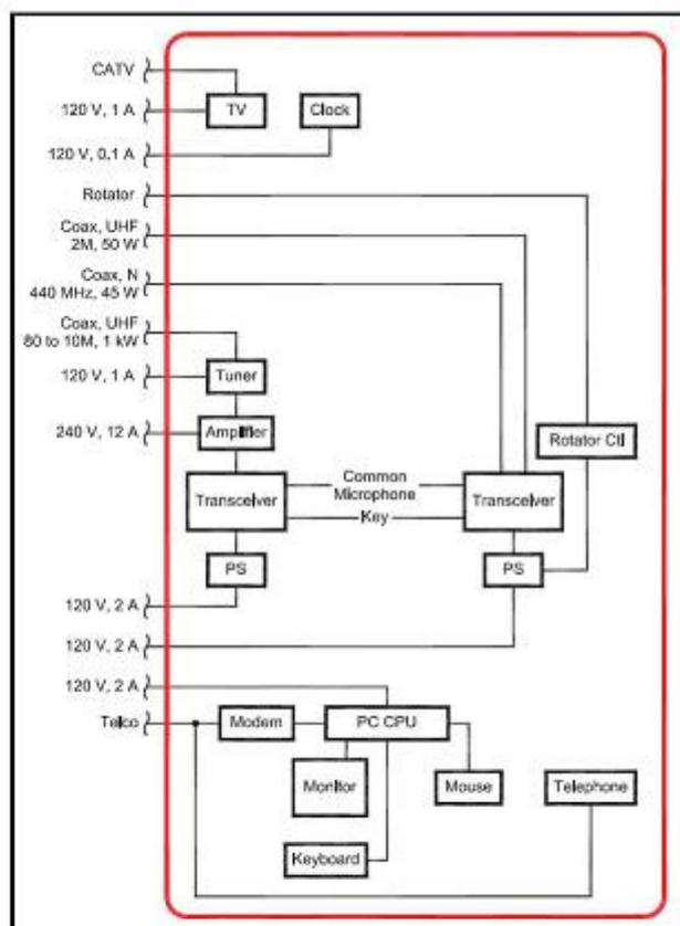
Рисунок 5. Входы/выходы радиостанции, которые должны быть защищены.
