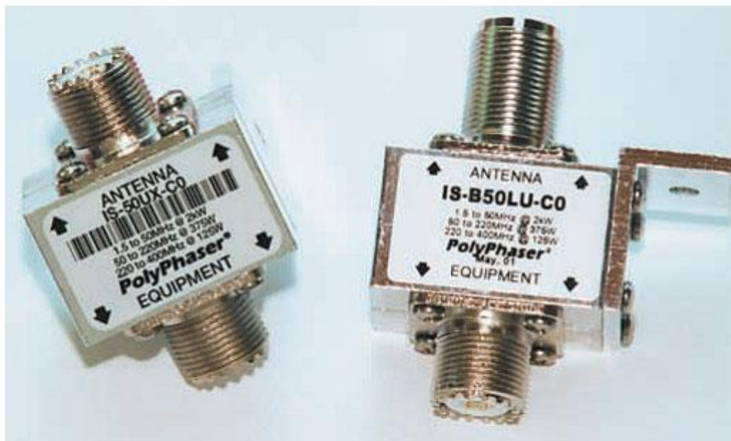
Рисунок 6. Типовые коаксиальные протекторы PolyPhaser IS-50UX и IS-B50LU.
