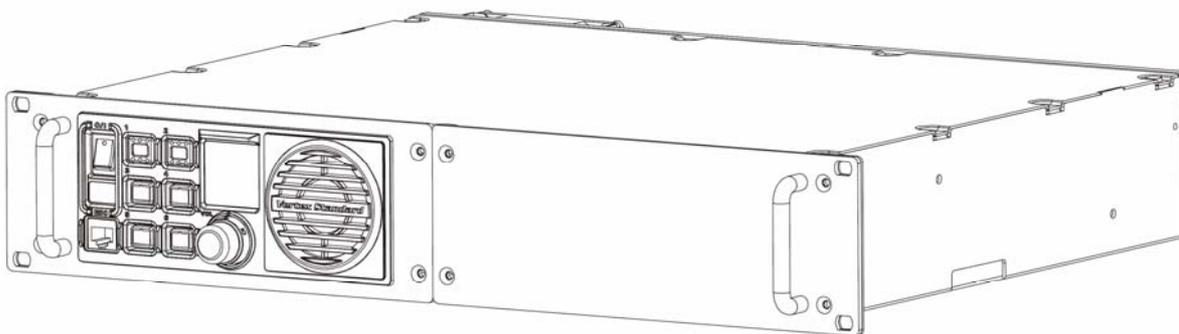
VXR-9000 – это 50-ти ваттный FM ретранслятор, предназначенный для обеспечения надежной двусторонней полнодуплексной связи.
