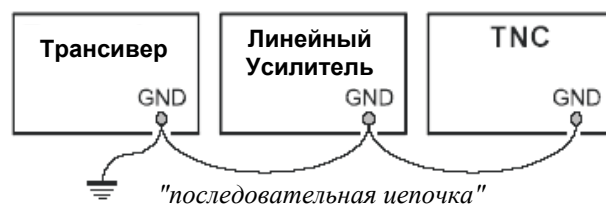
Неправильное заземление
