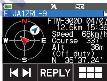
Пример отображения при приеме сигнала APRS
